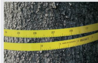
Rollmeter für Umfang- und Durchmesser-Messungen von Rohren, Bäumen etc.
